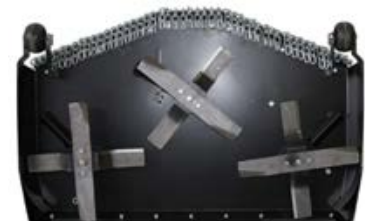
Hochgrasmäherwerk mit 6 Messern
